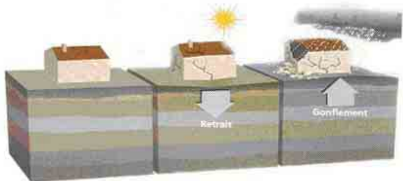
Figure 104 : Retrait/gonflement des argiles
